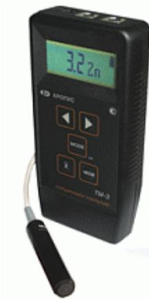
TM-3 вихретковый толщиномер для локального измерения толщины гальванических покрытий
