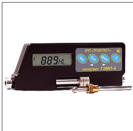
Беспроводной твердомер по функциональным возможностям представляет собой одну из модификаций широко используемого в промышленности серийного электронного переносного твердомера ТЭМП-4к и позволяет работать в зимних условиях (до  $-30^{\circ}\text{C}$ ), при повышенных температурах (до  $70^{\circ}\text{C}$ ), а также в условиях недостаточной освещённости благодаря регулируемой подсветке.
