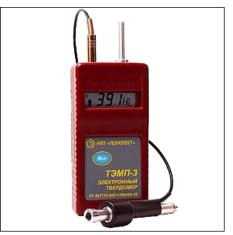
Малогабаритный твердомер ТЭМП-3 предназначен экспрессного измерения твердости различных изделий (из стали, чугуна, цветных металлов, резины и др. материалов) в лабораторных производственных условиях. И измерений выводится на индикатор в условных единицах (HL), переводимых в числа твердости (HB, HRC, HV, HSD) с помощью переводных таблиц, поставляемых вместе с твердомером. Твердомер малогабаритный ТЭМП-3 выпускается взамен снятого с производства твердомера ТЭМП-1.
